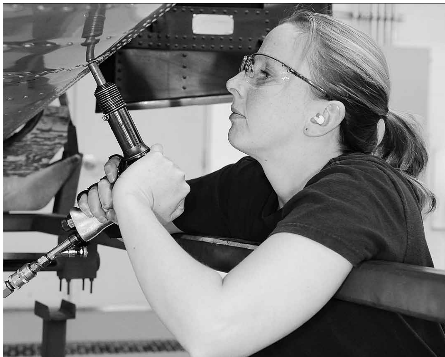
Cpl Trina Kozlik, an aircraft structures technician, rivets the exterior of the tail end of a CT-114 Tutor aircraft at the Aerospace Engineering Test Establishment at Cold Lake, Alberta. La caporal Trina Kozlik, technicienne en structures d'aéronefs, rivette l'extérieur de l'extrémité arrière d'un aéronef CT-114 Tutor au Centre d'essais techniques (Aérospatiale), à Cold Lake, en Alberta.
